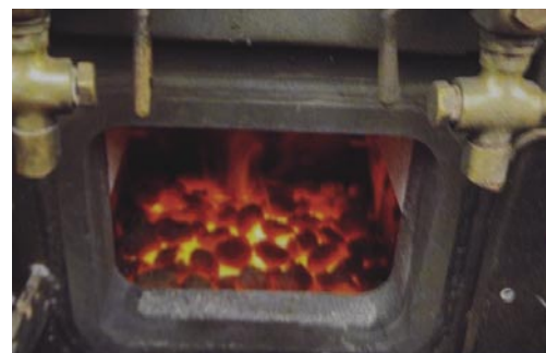
Rostyta som i en ångslup men med mycket större fyrlucka än någon av oss har.
