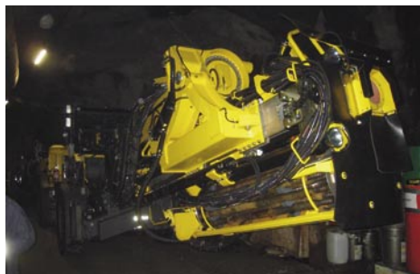
Borrmaskin som kan fjärrstyras.
