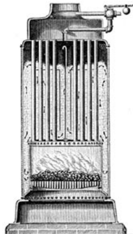
Bild 1: Vanlig stående eldrörspanna. I tubsatsen har monterats plåtar, för att förhindra vattenstänk upp i ångrummet och istället styra ångblåsorna ut mot manteln. Vattnet cirkulerar nedåt längs manteln, ånga och vatten uppåt, längs eldstaden och tuberna.
