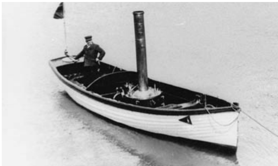
Typisk brittisk ångslup med ångpanna av typ ”Kingdon”
