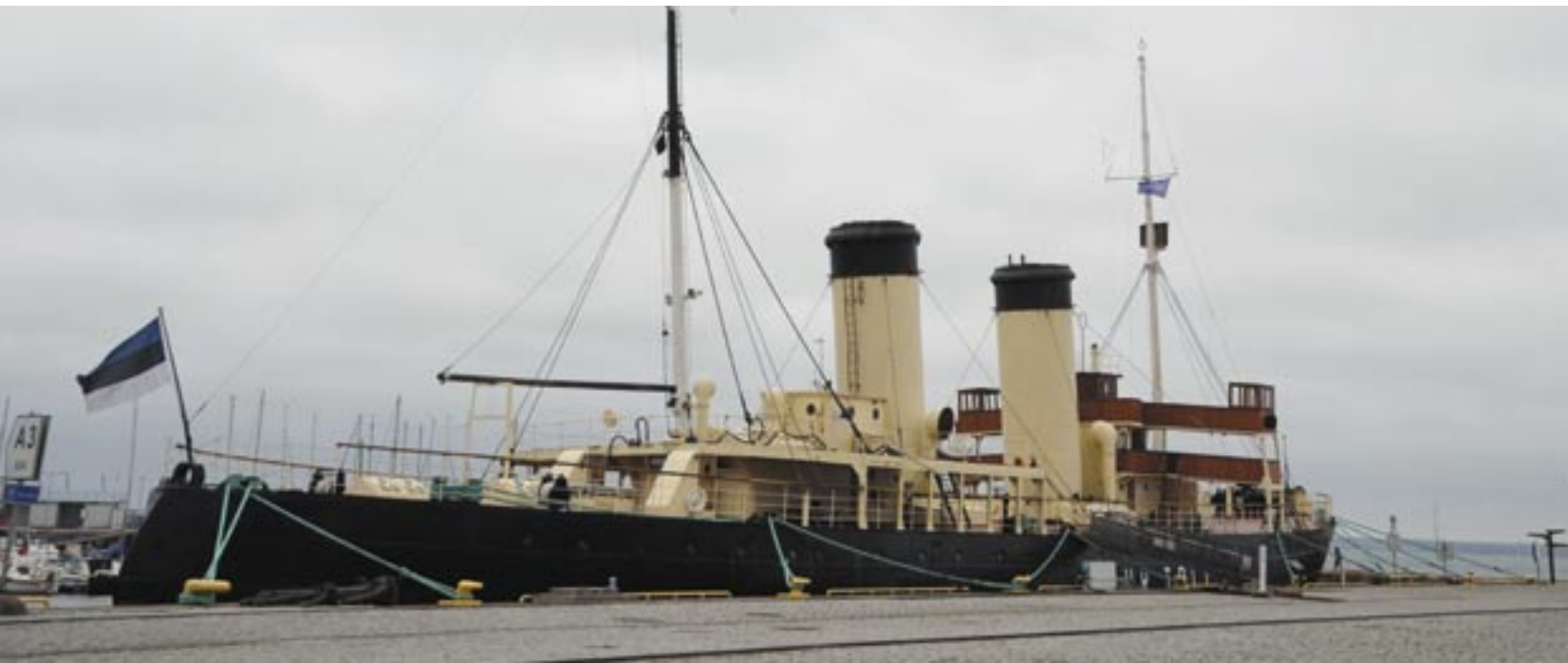
Isbrytaren s/s Suurtöll vid kaj i Tallinn. Den har tre likadana maskiner varav en i fören för att pumpa bort vatten och is.
