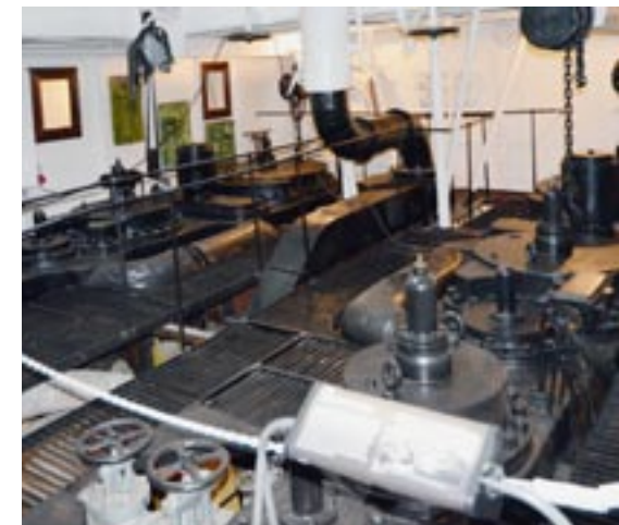
Isbrytaren s/s Suurtöll vid kaj i Tallinn. Den har tre likadana maskiner varav en i fören för att pumpa bort vatten och is.
